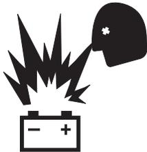
禁止火花、火焰和點燃的香煙靠近電池。電池能夠釋放出易爆氣體。
