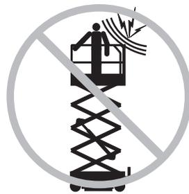
如果機器接觸到帶電的電線時，請遠離機器。地面或工作臺上的人員禁止觸摸或操作機器直至帶電的電線被切斷。
