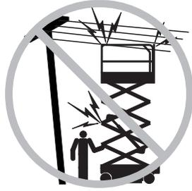
遵循關於與電源線之所需間隙的所有地方及政府規章。至少必須遵循下表所包含的所需間隙。
