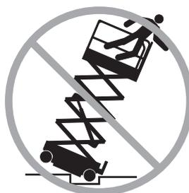
在收起位置下，當機器在不平坦的地形上、有碎石、不穩定或光滑的表面、靠近洞口和陡坡等處行駛時，要極端小心並降低速度。
