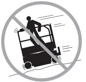
根據地面狀況、擁塞程度、坡度、人員位置和可能導致碰撞的任何其他因素，限制行進速度。
