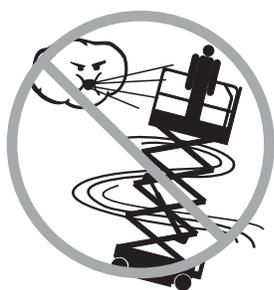
強風或陣風時請勿操作機器。請勿增加工作臺或載荷的表面積。增大暴露在風中的面積將降低機器的穩定性。
