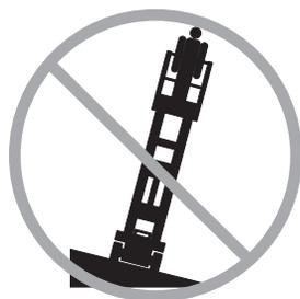
請勿把傾斜警示鈴當成水平指示器。只有當機器傾斜時底盤上的傾斜警示鈴才發出聲音。
